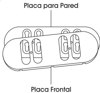
1. Use dos orificios para tornillos en la placa para pared como guía para marcar la pared en la ubicación deseada. (Vea Diagrama 2)
