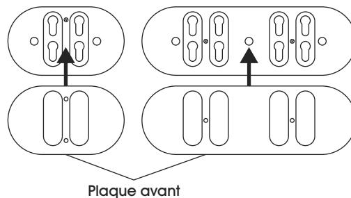
4. Enclinez les attaches pour accessoires sur le distributeur. (Voir Figure 4)
