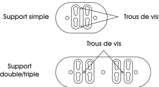
2. Vissez la plaque murale au mur en utilisant les trous de vis préalablement marqués.
