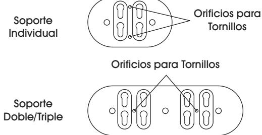
2. Atornille la placa posterior a la pared usando los orificios para tornillos anteriormente marcados.
