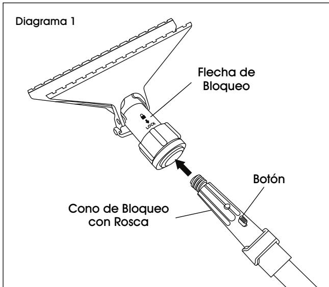
2. Gire el collar de bloqueo en sentido contrario a las manecillas del reloj para abrir y en sentido de las manecillas del reloj para asegurar las herramientas de limpieza en la pinza. (Vea Diagrama 2)
