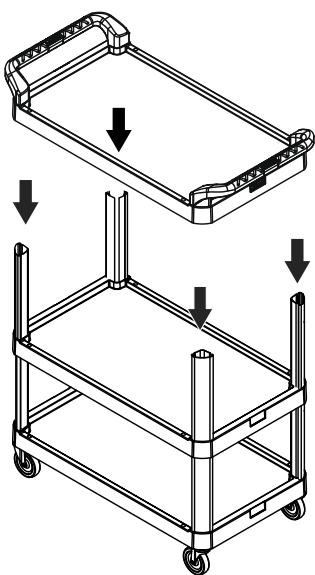
6. Insérez les poignées dans la tablette supérieure à l'aide du maillet en caoutchouc. Insérez les vis dans la partie inférieure de la tablette supérieure et fixez à l'aide du tournevis cruciforme. (Voir Figure 6)
