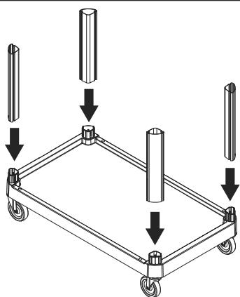
3. Con el mazo de caucho dé golpes a los soportes para meterlos en la repisa inferior. (Vea Diagrama 3)
