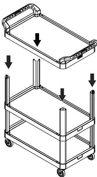
6. Con el mazo de caucho dé golpes a las asas para meterlas en la repisa superior. Inserte los tornillos en la parte inferior de la repisa superior y asegure las asas utilizando un desarmador de cruz.
