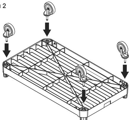
2. Con el mazo de caucho dé golpes a las ruedas para meterlas en los conectores para ruedas.
