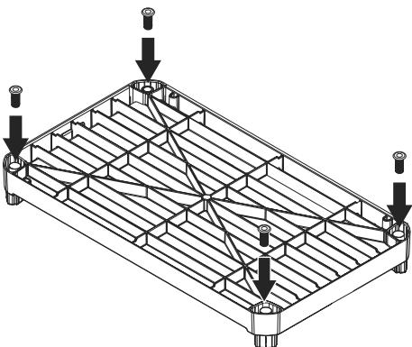
1. Insérez les douilles de roulette dans chaque coin de la tablette et tapotez à l'aide du maillet en caoutchouc jusqu'à ce qu'elles soient bien en place. (Voir Figure 1)
