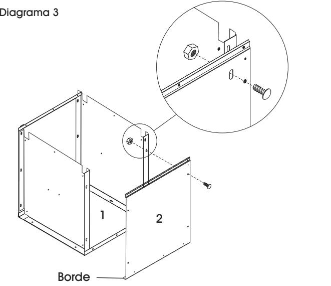
4. Una el panel lateral derecho (2) a los paneles posterior, superior e inferior usando siete tuercas y pernos. (Vea Diagrama 3)
