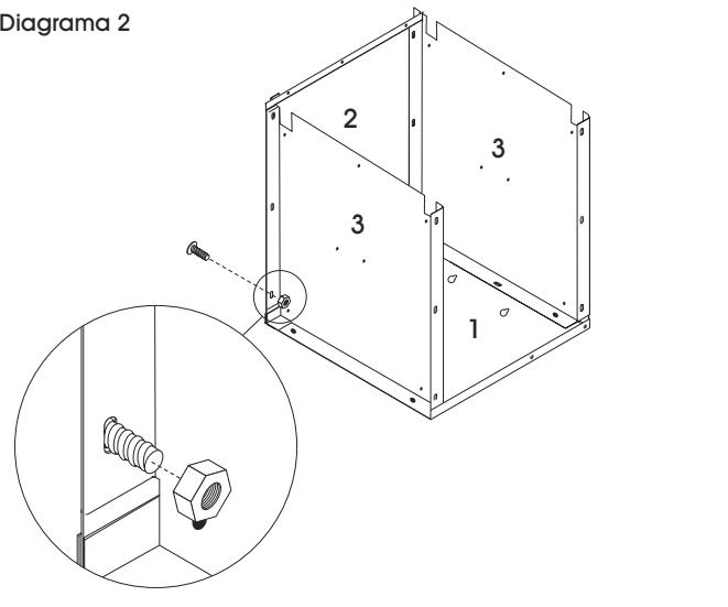
3. Una los paneles superior e inferior (3) a la parte posterior y el panel lateral izquierdo usando ocho tuercas y pernos. (Vea Diagrama 2)
