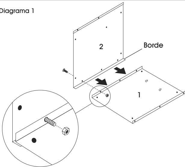
NOTA: No apriete los pernos hasta que la unidad esté completamente ensamblada.
