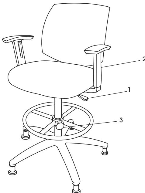
1. Ajuste de la Altura del Asiento – Para subir la altura del asiento, levante la palanca sin o con poco peso en el asiento. Para bajar la altura del asiento, levante la palanca mientras está sentado.
