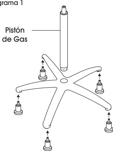
1. Inserte los niveladores en las patas de la base estrella. Enderece la base. Inserte el pistón de gas en el centro de la base. (Vea Diagrama 1)
