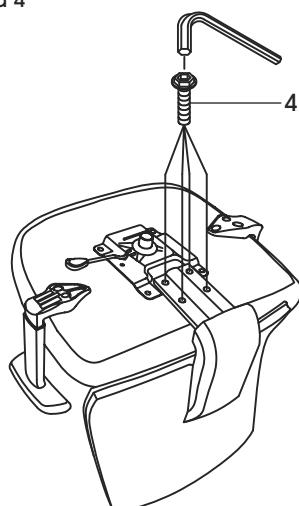
4. Alinee la placa de instalación del respaldo con los orificios en la parte inferior del asiento. Use cuatro tornillos de 5/16 x 1 1/2" (4) y la llave Allen para fijarlo. (Vea Diagrama 4)
