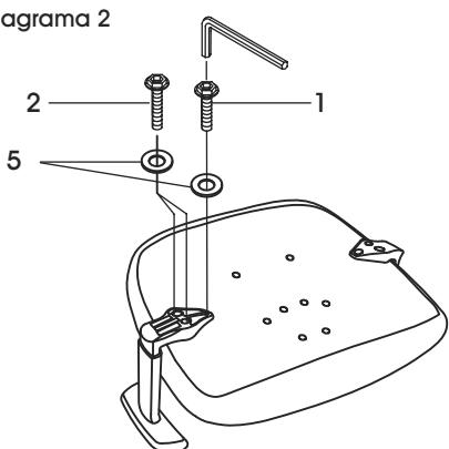
2. Alinee el descansabrazos con los orificios en la parte inferior del asiento. Use dos tornillos de 1/4 x 1 3/4" (2) y un tornillo de 1/4 x 1 1/2" screws (1) con tres rondanas (5) para fijarlo. Repita la operación con el lado opuesto. (Vea Diagrama 2)
