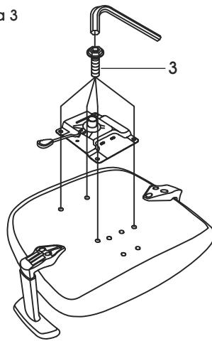
3. Alinee el mecanismo con los orificios preperforados en la parte de abajo del asiento acojinado. Fije el mecanismo al asiento usando cuatro tornillos de 5/16 x 1" (3) y la llave Allen. (Vea Diagrama 3)
