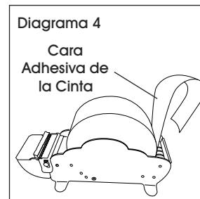
3. Inserte el extremo de la cinta en la parte posterior de dos rodillos. Empuje la cinta a través del lado inferior del despachadora hasta que el extremo salga por la parte de adelante de la base para cinta. (Vea Diagrama 5)
