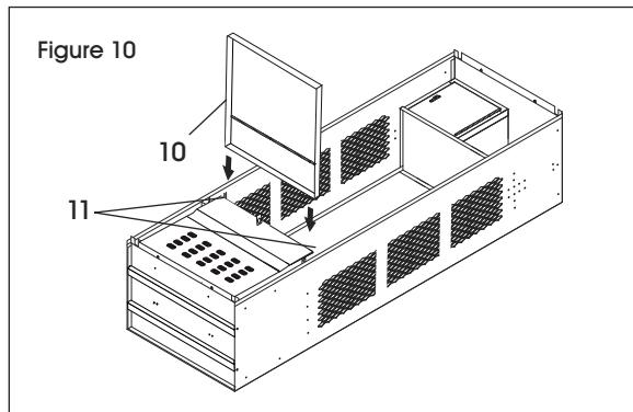
12. Boulonnez le plus petit panneau rectangulaire du couvercle de coffre bas (10) aux rails de guidage (11) des deux côtés. Le moraillon de cadenas situé sur le couvercle de coffre bas (10) doit être aligné avec le moraillon situé sur la façade du coffre bas (9). (Voir Figure 11)
