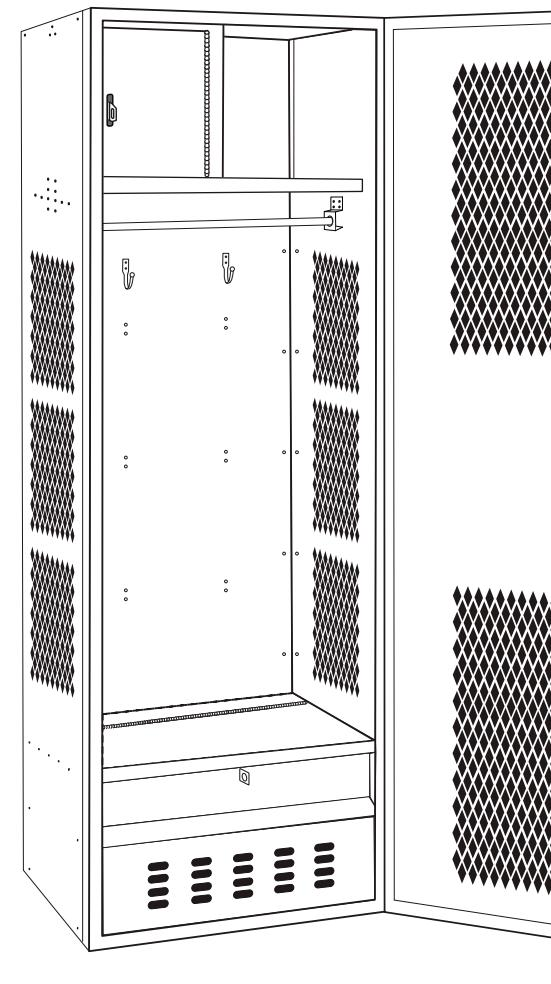
16. Boulonnez un support de tringle (14) à l'un des panneaux latéraux (2). Insérez ensuite la tringle (13) dans le support de tringle (14) boulonné au panneau latéral (2). Placez le second support de tringle (14) sur l'autre extrémité de la tringle (13). Boulonnez le second support de tringle (14) à l'autre panneau latéral (2). (Voir Figure 14)
