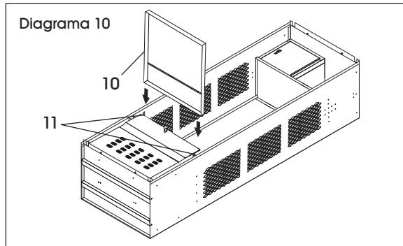
12. Una el panel rectangular más pequeño de la cubierta del cajón inferior (10) a los rieles del cajón inferior (11) en ambos lados. El pestillo del candado en la cubierta del cajón inferior (10) debe alinearse con el pestillo en el frente del cajón inferior (9). (Vea Diagrama 11)
