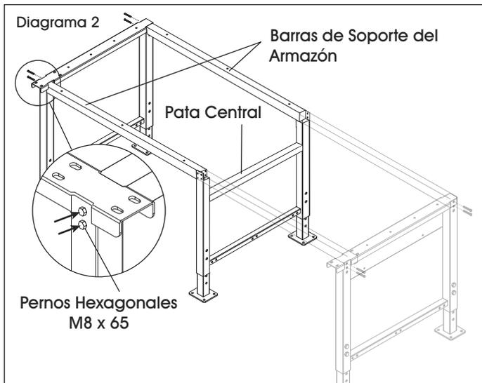
3. Coloque la barra de soporte de la pata central (6) entre las barras de soporte del armazón (4) encima de la pata central. Fije la barra de soporte de la pata central a las barras de soporte del armazón y la pata central (1) con ocho pernos hexagonales M8 x 65 utilizando una llave de 13 mm. (Vea Diagrama 3)
