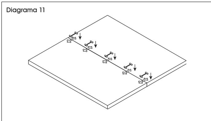
4. Usando una llave de 7/16", apriete el sujetador para que ambas secciones queden bien fijas. Alinee las caras y los extremos para que estén bien a ras antes de apretar las juntas por completo. Ajuste cada sección levemente con una pieza de madera y un mazo de caucho para evitar daños a la cubierta, después termine de apretar.
