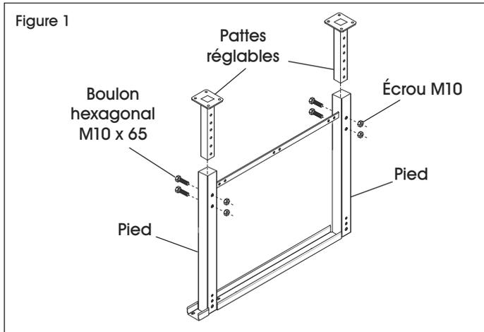
2. Mettez les pieds à l'endroit et écartez-les pour y installer les barres de support de cadre (4). Positionnez les barres de support de cadre en orientant les trous qui sont plus larges vers le bas. L'extrémité ouverte des barres doit être positionnée sur le pied central (1). Fixez les barres de support au pied extérieur (2) à l'aide de quatre boulons hexagonaux M8 x 65 par pied en vous servant d'une clé de 13 mm. (Voir Figure 2) Répétez de l'autre côté.
