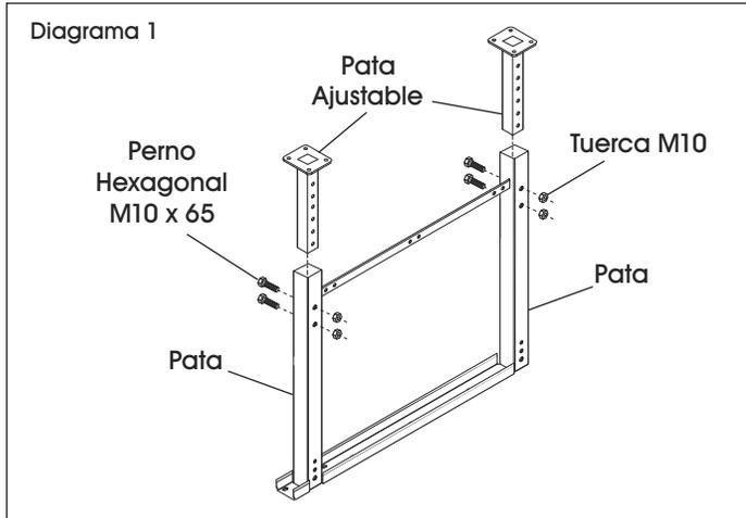
2. Voltee las patas hacia arriba y sepárelas para acomodar las barras de soporte del armazón (4). Coloque las barras de soporte del armazón de tal manera que los orificios más grandes queden hacia abajo. El extremo abierto de las barras de soporte del armazón debe posicionarse en la pata central (1). Fije las barras de soporte a la pata exterior (2) con cuatro pernos hexagonales M8 x 65 por cada pata utilizando una llave de 13 mm. (Vea Diagrama 2) Repita para el otro lado.
