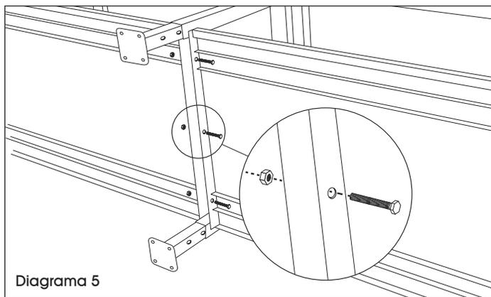
2. Fije el extremo de cada repisa al soporte para patas de las patas exteriores con seis pernos M8 x 35 y seis tuercas M8 por repisa utilizando una llave de 13 mm. (Vea Diagrama 6)
