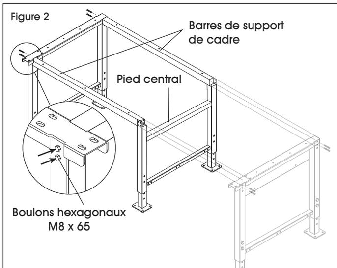
3. Placez la barre de support pour pied central (6) entre les barres de support de cadre (4) sur le dessus du pied central. Fixez la barre de support du pied central aux barres de support de cadre et au pied central (1) à l'aide de huit boulons hexagonaux M8 x 65 et d'une clé de 13 mm. (Voir Figure 3)
