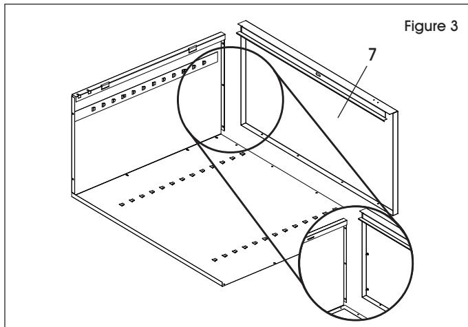
bride latérale sur le panneau latéral. Les goujons filetés doivent s'insérer dans les trous de la bride supérieure du panneau latéral et être fixés à l'aide de trois écrous. Fixez le panneau arrière au panneau supérieur à l'aide de quatre boulons et écrous. (Voir Figure 3)
