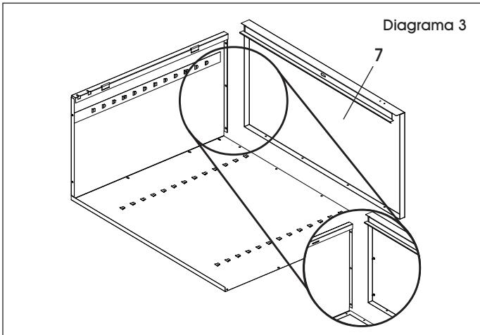
reborde lateral en el panel lateral de la unidad. Los remaches roscados deberán insertarse en los orificios del reborde superior del lateral y fijarse con tres tuercas. Una el panel posterior al superior usando cuatro pernos y tuercas. (Vea Diagrama 3)
