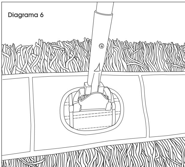
5. El mango del trapeador para polvo gira 360°. Para permitir que el mango gire en cualquier dirección, jale el collar de nylon deslizante hacia arriba. (Vea Diagrama 7)
