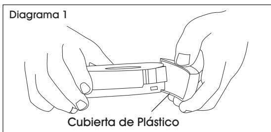
2. Presione la pestaña de bloqueo y abra la cubierta transparente. (Vea Diagrama 2)
