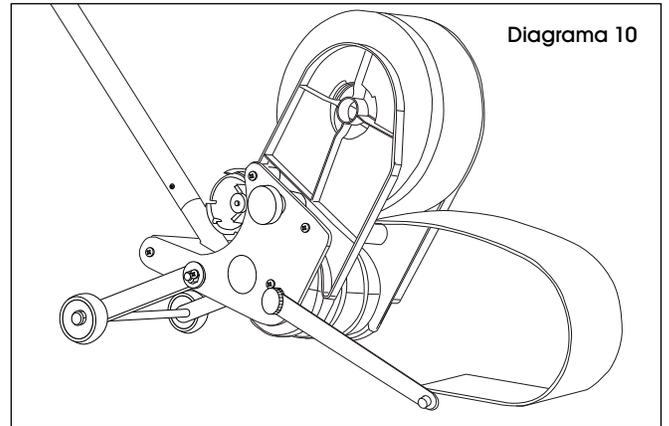
3. Levante el aplicador y muévelo hacia adelante hasta que la cinta esté descansando tensa contra el rodillo. (Vea Diagrama 11)
