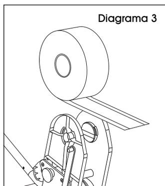
4. Inserte el rollo de cinta entre los paneles, asegurándose de que los soportes redondos se ajusten en el núcleo de la cinta. (Vea Diagrama 4)
