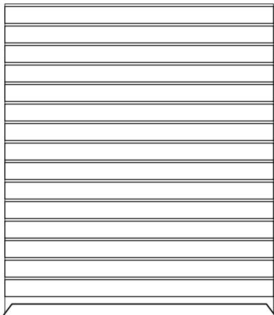
5. Repita el paso cuatro con los paneles ranurados restantes hasta que todos estén instalados. (Vea Diagrama 5)
