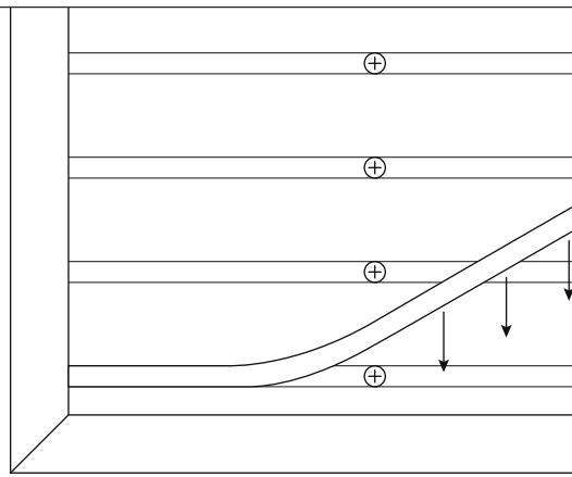
7. Para ocultar por completo las cabezas de los tornillos, retire el dorso de las tiras adhesivas de color y presiónelas en cada ranura de los paneles ranurados. (Vea Diagrama 7)
