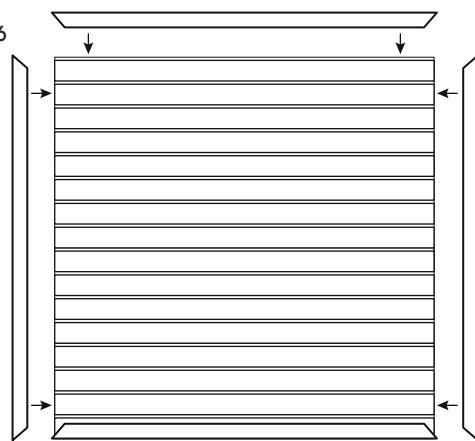
6. Faites glisser en place les trois garnitures en J coupées en onglet restantes. Ajustez jusqu'à ce que les coins s'emboîtent. Serrez toutes les vis au mur. (Voir Figure 6)
