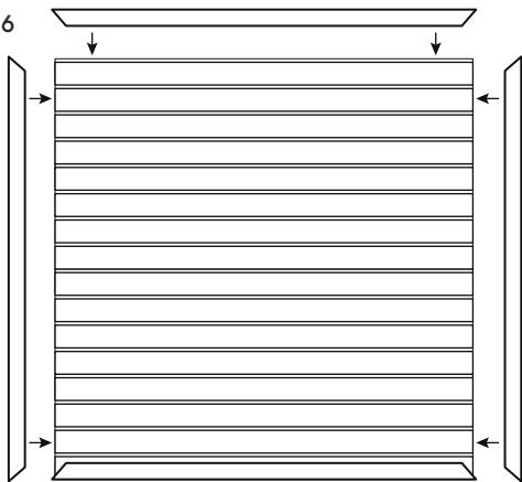
6. Deslice en su lugar las tres piezas con corte angular restantes. Ajuste hasta que las piezas de las esquinas encajen entre sí. Apriete todos los tornillos a la pared. (Vea Diagrama 6)
