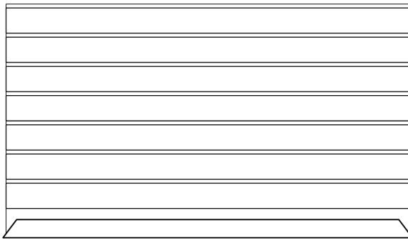
2. Con la pieza con corte angular en J instalada, centre uno de los cuatro paneles ranurados en el canal de la pieza angular con el extremo macho orientado hacia arriba. Asegúrese de que ninguno de los extremos del panel se extienda más allá de los extremos de las piezas con corte angular en J. (Vea Diagrama 2)
