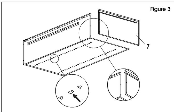
4. Boulonnez le panneau latéral droit (3) au panneau arrière de la même manière qu'à l'étape 2. Assurez-vous que la bride est positionnée derrière le panneau arrière et que tous les supports de tablette pointent dans la même direction que ceux du panneau arrière et du panneau latéral gauche. Poussez le panneau latéral droit vers le haut afin que les goujons de la tablette supérieure s'insèrent dans les trous de la bride supérieure du côté et fixez à l'aide de trois écrous. (Voir Figure 4)
