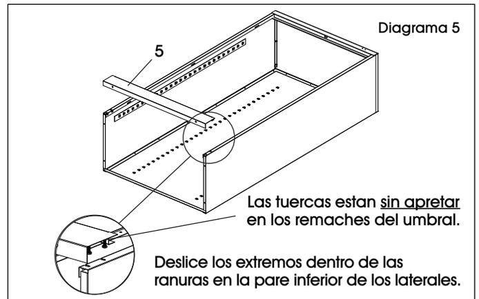
6. Coloque la pestaña posterior de la parte inferior (6) en las lancetas de abajo por detrás y los laterales. La pestaña con dos orificios debe apuntar hacia el frente, colgando sobre el umbral. Inserte los pernos a través de la parte inferior y el umbral con la cabeza apuntando al frente de la unidad. Asegure con dos tuercas. (Vea Diagrama 6)
