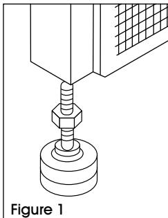
2. Insérez le patin de nivellation et l'écrou dans le pied de base en T et dans le bas du cadre du panneau. (Voir Figure 2)
