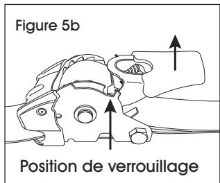
5. Une fois en position de verrouillage, déplacez la poignée de haut en bas pour serrer la sangle. Remettez la poignée en position de verrouillage lorsque suffisamment serrée. (Voir Figures 6a - 6c)
