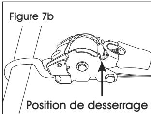
7. En position de desserrage, décrochez la sangle à cliquet des points d'ancrage et appuyez sur le bouton rouge pour rétracter. (Voir Figure 8)
