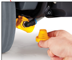
Filtro del Tanque de Detergente
