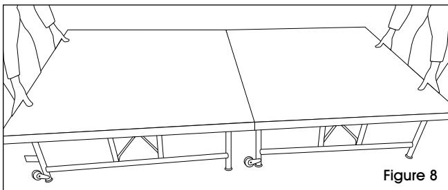
3. Pour séparer les pièces, soulevez la plateforme de sorte que le bord intérieur s'incline vers le bas et les crochets se relâchent. Séparez les deux pièces en les roulant l'un loin de l'autre. (Voir Figure 9)
