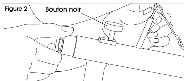
3. Faites glisser le tube de pied argenté de l'intérieur à l'extérieur jusqu'à la hauteur voulue. Alignez le trou du tube de pied sur celui du tube extérieur noir. (Voir Figure 3)
