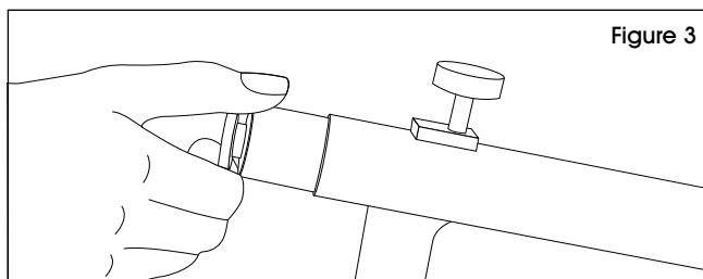
4. Réinsérez la goupille en acier à travers les trous alignés. Serrez fermement le bouton noir pour fixer le tout en place. (Voir Figure 4)
