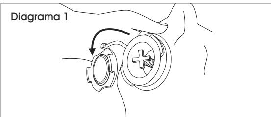
2. Asegúrese de que la válvula interior esté cerrada. La válvula está cerrada cuando la clavija central está en posición vertical. Si está abierta, gire la cruz en el sentido de las agujas del reloj hasta que el resorte haga pop, cerrando la válvula. (Vea Diagrama 2)
