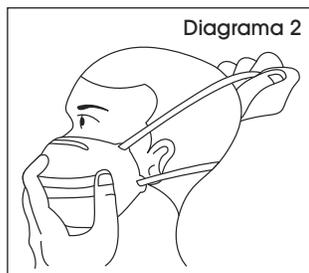
4. Para revisar el ajuste, coloque ambas manos sobre el respirador e inhale con fuerza. Una presión negativa se debe sentir dentro del respirador. Si siente aire circulando alrededor de su nariz, apriete clip. Si el aire se escapa por los alrededores, apriete las bandas para un mejor ajuste. (Vea Diagrama 4)
