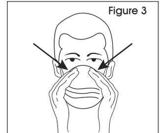
4. Pour vérifier l'étanchéité, placez les mains sur le respirateur et respirez profondément. Une pression négative devrait s'exercer à l'intérieur du respirateur. Si l'air s'échappe autour du nez, resserrez la coque nasale. Si l'air s'échappe autour des bords, repositionnez les brides pour un meilleur ajustement. (Voir Figure 4)
