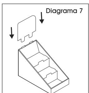
4. Coloque el inserto en el exhibidor. Las lengüetas del lateral del inserto deben quedar alienadas e insertadas en las ranuras de los paneles laterales del exhibidor. (Vea Diagrama 4)
