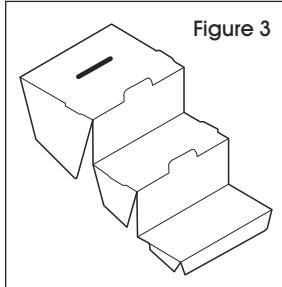
4. Placez l'encart dans le présentoir. Les languettes sur le côté de l'encart doivent s'aligner et s'encliquer dans les fentes sur les panneaux latéraux du présentoir. (Voir Figure 4)
