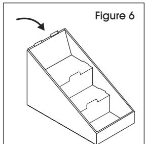
7. Insérez l'en-tête. Les languettes de l'en-tête doivent s'insérer dans les fentes dans les plis du panneau arrière. (Voir Figure 7)
