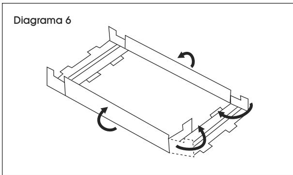
2. Doble el panel del extremo hacia arriba y por encima para asegurar las pestanas dentro de las ranuras. (Vea Diagrama 7)
