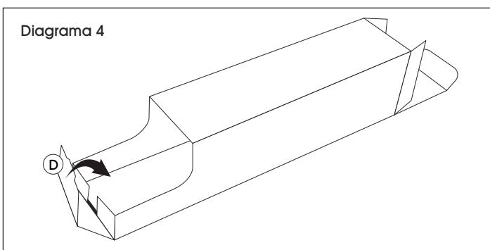
2. Doble por las líneas marcadas con un 2. Doble A hacia dentro (B debe quedar en el exterior).
