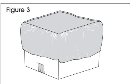
5. Versez une couche uniforme d'au moins 4,22 cm (1,66 po) de vermiculite de calibre 4 dans le fond du sac en polyéthylène.
