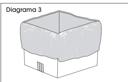
5. Vierta una capa uniforme de un mínimo de 4.22 cm (1.66") de Vermiculita Grado 4 en el fondo de la bolsa de polietileno.
