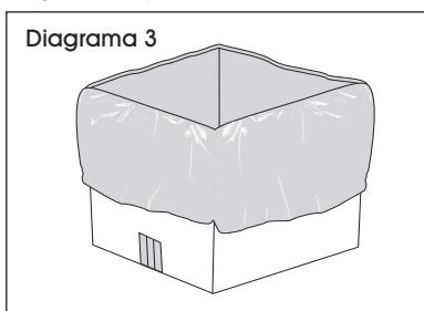
5. Vierta una capa uniforme de un mínimo de 7.34 cm (2.89") de Vermiculita Grado 4 en el fondo de la bolsa de polietileno.
