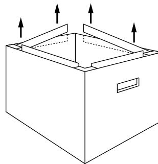
4. Pour suspendre des dossiers en format lettre, insérez les bandes en plastique sur les longs côtés de la boîte au-dessus de la partie perforée. (Voir Figure 4)
