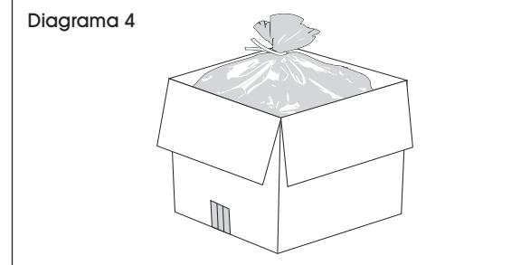
9. Doble las solapas de la parte superior de la caja de cartón de forma que coincidan. La advertencia "THIS SIDE UP" (Este lado hacia arriba) debe quedar a la vista en la parte exterior de la caja.
