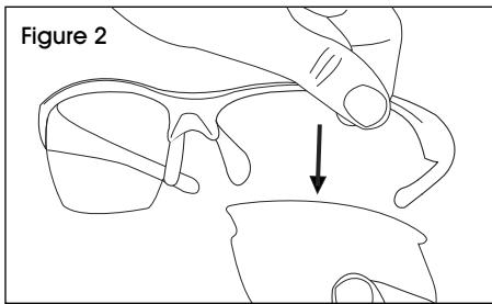
2. Décrochez d'abord la lentille de gauche du côté tempe de la monture en séparant simultanément la monture et la lentille l'une de l'autre. (Voir Figures 3 et 4)
