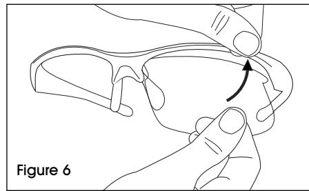
2. Poussez d'abord la lentille de gauche vers le haut du côté nasal de la monture, puis encliquez la lentille dans le côté tempe de la monture. (Voir Figures 7 et 8)
