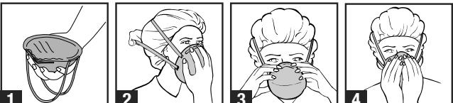
1. Placer le respirateur dans le creux de la main, la pince nasale sur le bout des doigts, en laissant pendre les courroies librement.
