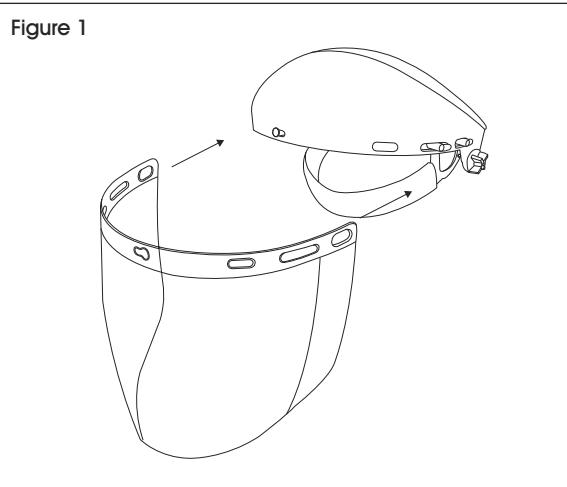
3. Poussez l'écran facial latéralement jusqu'à ce que l'encoche centrale se verrouille en place. (Voir Figure 3)
