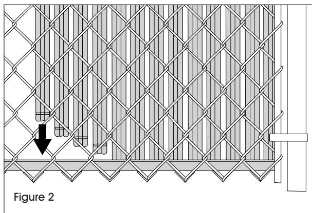
3. Enfoncez les lattes verticales dans le profilé inférieur pour les verrouiller en place. (Voir Figure 3)
