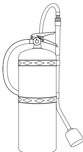
2. Fije el asa al extremo opuesto de la manguera con el acoplador de conexión rápida integrado. (Vea Diagrama 2)
