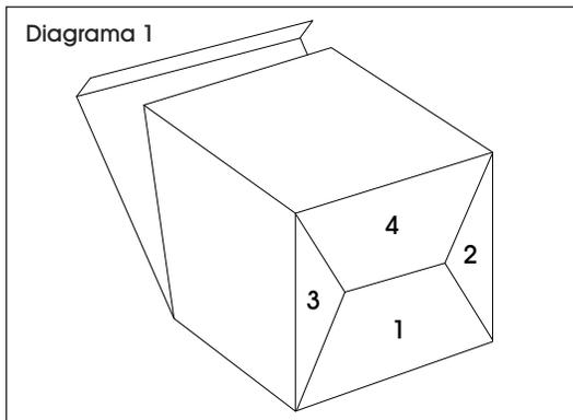
2. Coloque la caja de pie y doble las solapas superiores hacia dentro. Cierre la tapa. Inserte la lengüeta de bloqueo en la abertura correspondiente. (Vea Diagrama 2)
