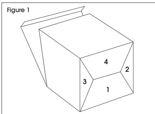
2. Mettez la boîte en position verticale et repliez les rabats latéraux du dessus. Fermer le couvercle. Pliez la languette de fermeture de sorte qu'elle s'insère dans la fente correspondante. (Voir Figure 2)
