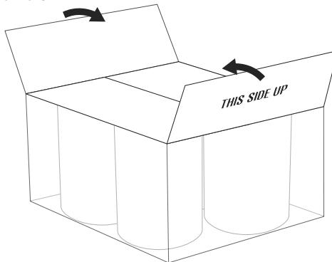
8. Selle la parte superior de la caja de cartón por la abertura central con una tira de cinta de polipropileno de 5 cm (2") de ancho (2 mil) (Uline Modelo # S-423). La cinta debe extenderse 7.6 cm (3") por cada uno de los extremos de la caja de cartón. (Vea Diagrama 6)
