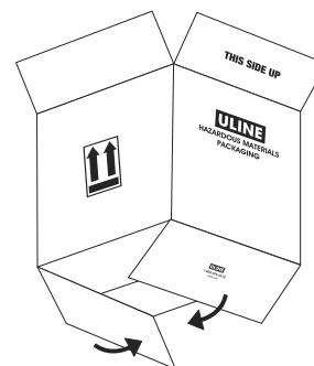
2. Scellez le dessous de la boîte le long de la jointure centrale à l'aide d'une bande de ruban adhésif en polypropylène (2 mil) de 5 cm (2 po) de largeur (n° de modèle Uline S-423). Le ruban adhésif doit dépasser de 7,6 cm (3 po) à chaque extrémité de la boîte. (Voir Figure 2)
