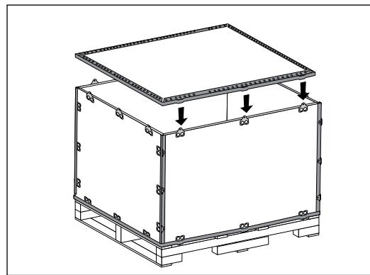
2. Asegure los paneles cortos a la base y a los laterales del panel largo.
