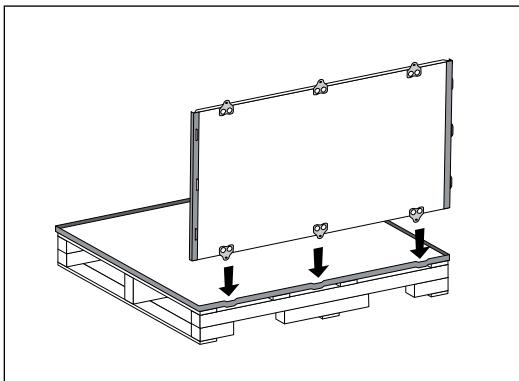
4. Asegúrese de que todos los paneles estén nivelados, luego coloque la tapa encima.
